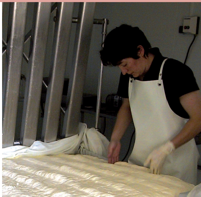
Le caillé est égoutté plusieurs fois à l'aide d'une presse pneumatique
